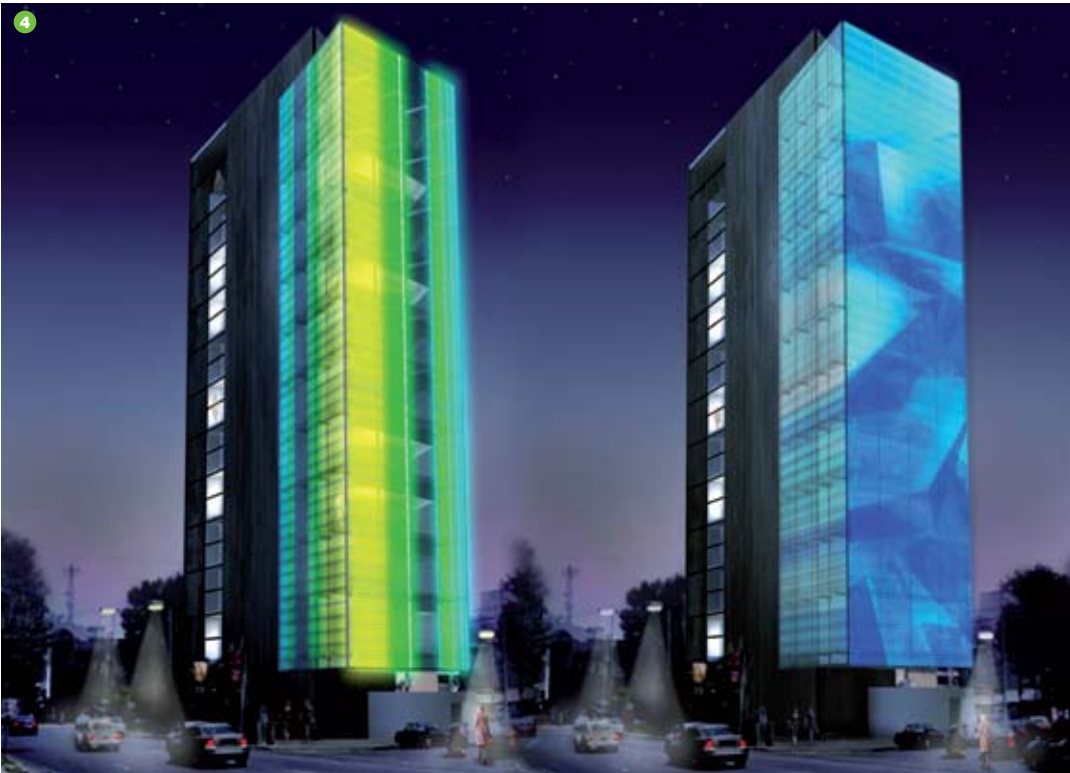
4. Mediamesh®, een roestvast stalen gevelhekwerk waarin LED's zijn geweven. Ontwerp: ag4 media facade GMBH en GKD. 5. Grey Cube, textiele studie.
